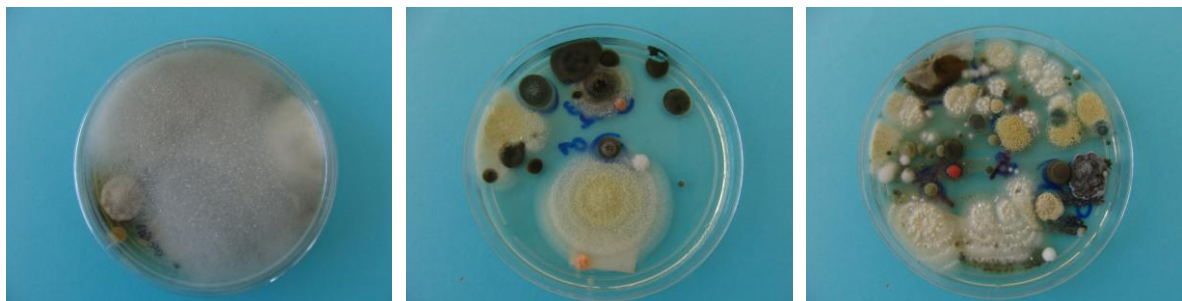
Figura 3 – Crescimento das unidades formadoras de colônia de fungos causadores do bolor
