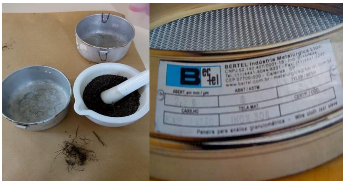
Figura 1: Maceração do solo e peneira utilizada para reter partes maiores do solo como pedras, galhos e raízes.
