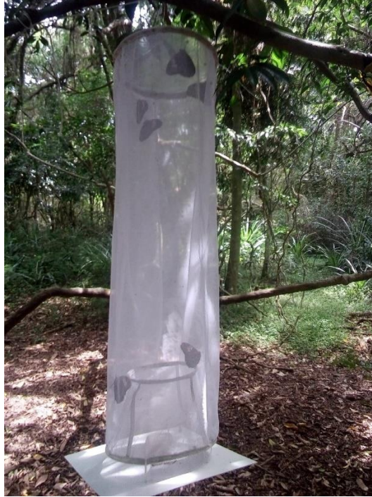
Figura 2 – Modelo de armadilha Van Someren-Rydon utilizada em cada Unidade Amostral. Foto: Taiane Schwantz de Moraes.
