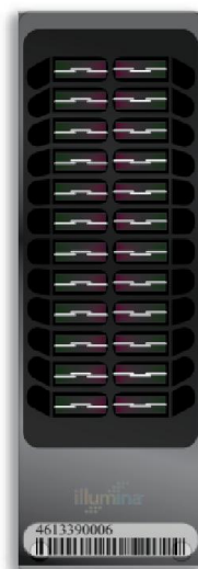
Figura 8 - BovineSNP50 Genotyping BeadChip, possui capacidade de avaliação de mais de 54.000 SNPs, suporta até 24 amostras simultâneas.
