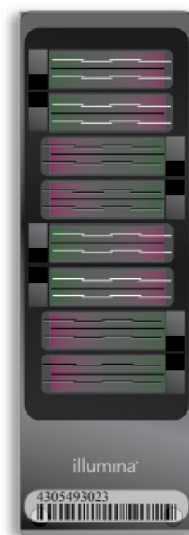
Figura 9 - BovineHD Genotyping BeadChip, possui capacidade de avaliação de mais de 770.000 SNPs, sendo possível analisar até 8 amostras simultaneamente.
