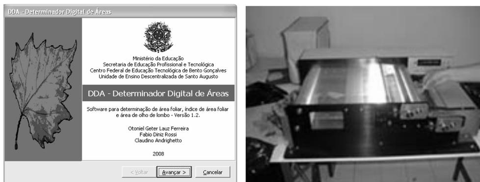
Figura 1: Janela de abertura do *software* DDA (Determinador Digital de Áreas), e Aparelho de determinação de área foliar tipo LI-COR 3100.
