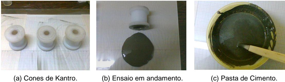
**Figura 2** – Materiais e equipamentos empregados no ensaio de mini-slump
