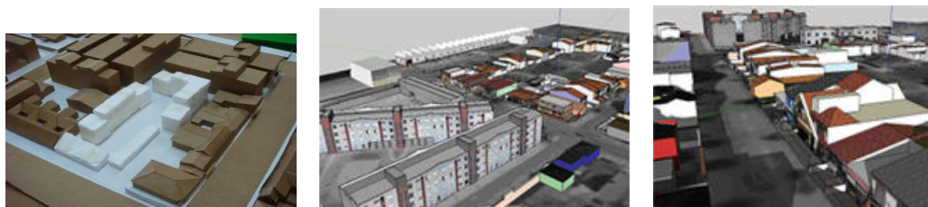
Figura 1: à esquerda, a maquete física, ao centro o modelo digital e à direita o modelo digital com simulação de sombras.
