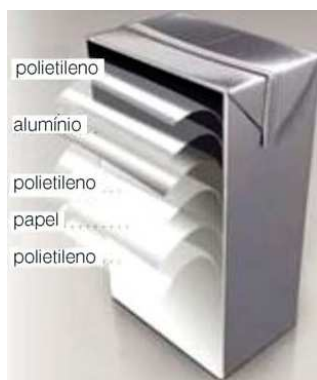
Figura 1 Multicamadas de uma embalagem de 1 litro utilizada para líquidos (Fonte: Revista Química e Sociedade)
