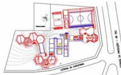
Figura 3: Planta de reforma e ampliação do Projeto arquitetônico da Escola Ministro Arthur de Souza e Costa, Estrada da Cascatinha, Pelotas/RS. (Legenda: vermelho= a construir; azul= existente; amarelo= a demolir).
