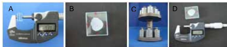
Figura 1: A) Placas sem ionômero de vidro sendo mensuradas. B) Placa de vidro com 225mm 2 de área e espessura de 5mm com os cinco pontos de medição marcados em vermelho, contendo o cimento de ionômero de vidro. C) Força de 150N sendo aplicada sobre as placas. D) Placas sobrepostas contendo cimento de ionômero de vidro sendo mensuradas.
